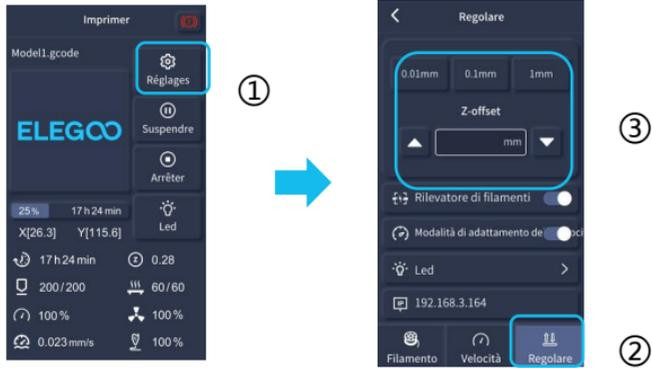
**NOTA:** mentre si esegue questa procedura durante la stampa per regolare finemente l' altezza dell' ugello, assicurarsi di cambiare la distanza di movimento al minor incremento possibile di 0.01mm o 0.1mm per evitare che l' ugello sfreggi contro il piatto riscaldato rovinandolo o per evitare che il filamento venga estruso in aria.
